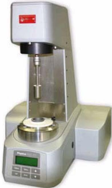
**Reómetro de Corte Dinámico**
