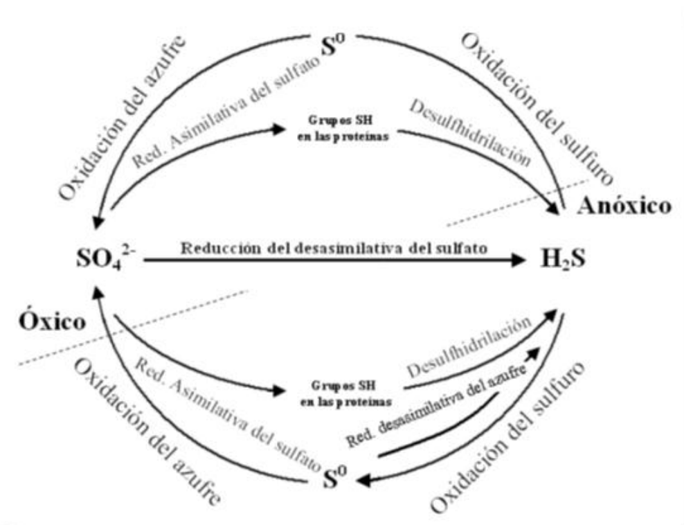
Figura 1. Etapas de formación de sulfuros en las redes de saneamiento
