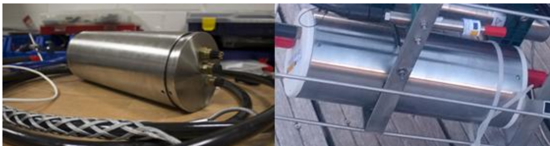
Figura 6: Dispositivo Electrónico de Adquisición y Envío de Datos “DAQ-AGUA”
