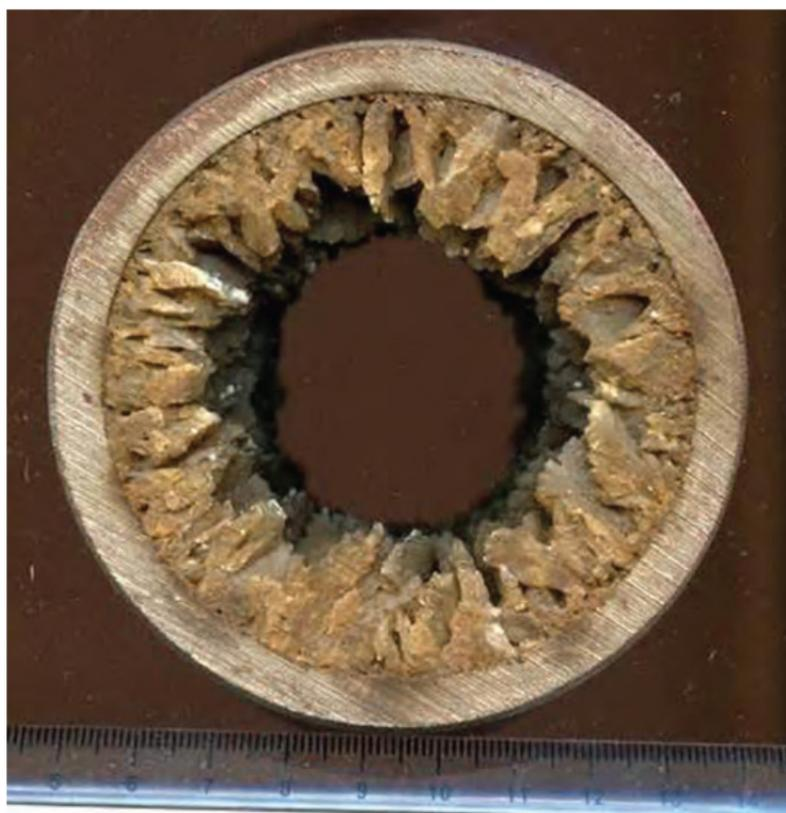
**Figura 2:** Incrustaciones de sulfato de bario en una tubería de perforación. El radio puede precipitar fácilmente con estas sales de bario y puede emitir radiaciones que afecten al personal que trabaja cerca de dicho equipo. También puede ser potencialmente liberado al medio ambiente si se elimina incorrectamente [23]
