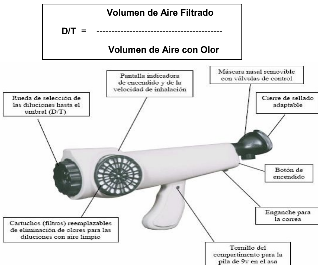
Figura 4. Diagrama de los componentes principales del Nasal Ranger™
