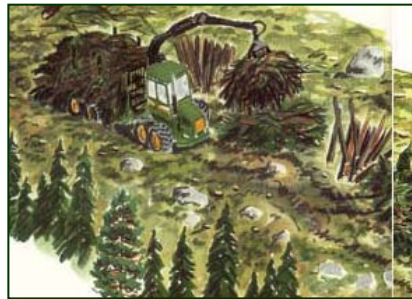
Desembosque con tractor forestal dotado de pulpo + contenedor. Transporte hasta cargadero.
