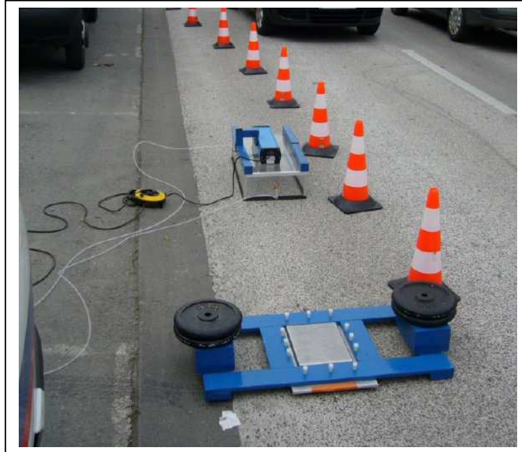
Figura 10. Ensayo “in situ” de determinación de eficiencia fotocatalítica
