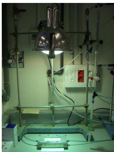
Figura 5. Cámara de ensayo de análisis de actividad fotocatalítica en laboratorio
