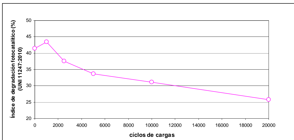
Figura 9. Curva de análisis de la resistencia al deslizamiento y eficiencia fotocatalítica de testigos extraídos en rodadura de tramo urbano.
